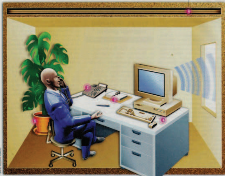
6 In einem Kabelschacht wird eine Wanze versteckt. Der Sender zapft die Telefonleitung an und ernährt sich von der hauseigenen Stromversorgung.
